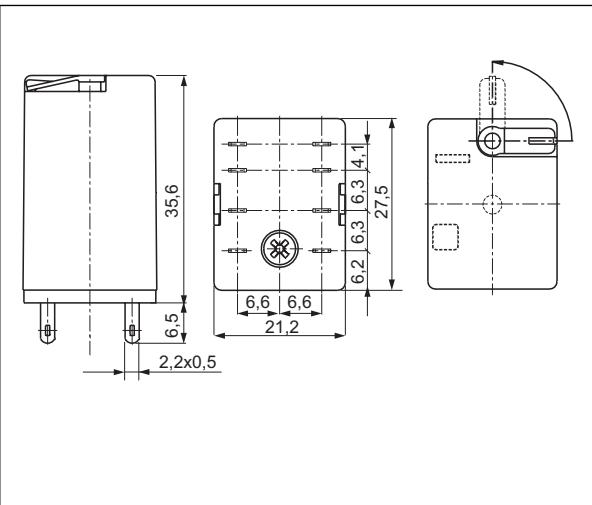
**Габаритные размеры - исполнение для контактных колодок, с тест-кнопкой без функции блокировки контактов или заглушкой**
