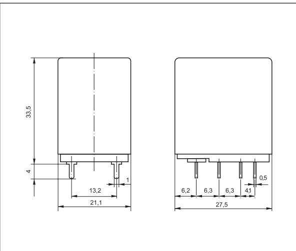
**Габаритные размеры - исполнение с крепежным винтом**
